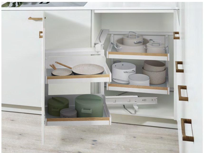
Eckauszug Magic Corner Standard: Beim Öffnen der Türe schwenken die daran befestigten Tablare nach aussen, während die hinteren Tablare automatisch in den vorderen Schrankbereich fahren.
