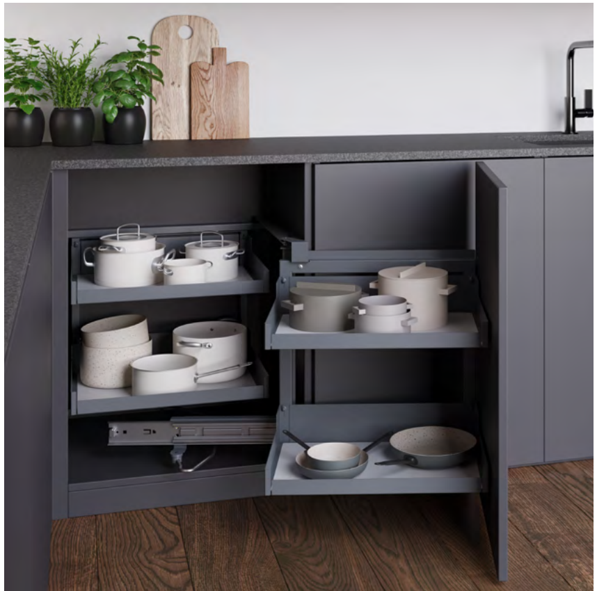
Eckauszug Magic Corner Standard: Beim Öffnen der Türe schwenken die daran befestigten Tablare nach aussen, während die hinteren Tablare automatisch in den vorderen Schrankbereich fahren.
